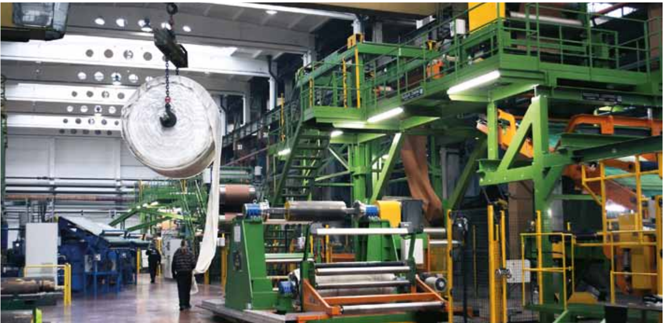
在现代化的压光机上生产输送机皮带（它被工人们称之为鲁道夫）
